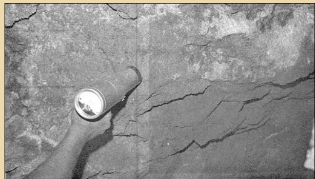
اندازه‌گیری پرتوهای گاما در رگه‌های اورانیوم‌دار به کمک سنتیلومتر
